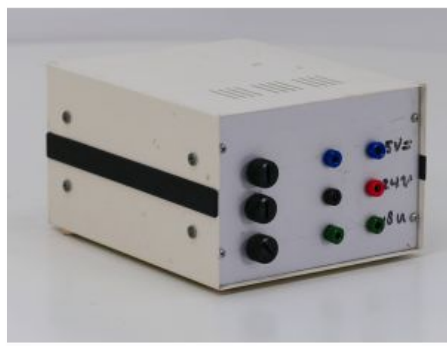
Trafo 5, 18 En 24 Volt 3x 3 Ampere
