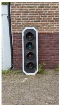
Hauptsignal Der RhB Rhatische Bahn Mitt 4 Leuchten
