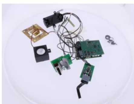
LGB 25703 MFX Sound Platine Gepulster Verdampfer Zillertal Lok
