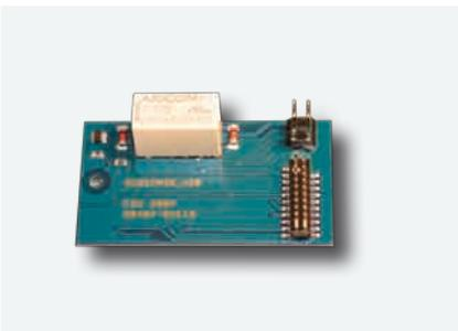
Viele Triebwagen sind an beiden Enden mit einem Schleifer versehen. Für eine ordnungsgemäße Funktion in Blockstellen und für das rechtzeitige Anhalten vor roten Signalen ist es unerlässlich, dass abhängig von der Fahrtrichtung nur ein Schleifer zur Stromversorgung des Decoders herangezogen wird.
