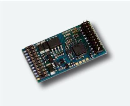
Mit dieser Erweiterungsplatine können Sie Ihren LokPilot V4.0 oder LokSound V4.0 Decoder (mit 21MTC-Schnittstelle!) elegant um erweitern: Stecken Sie den Decoder einfach auf den Baustein und nutzen Sie 8 weitere Funktionsausgänge (AUX5 bis AUX10) für Lichteffekte, Kupplung usw. Zudem können Sie 4 RC-Servos anschließen. Die nötige 5-Volt-Spannung wird auch bereitgestellt.
