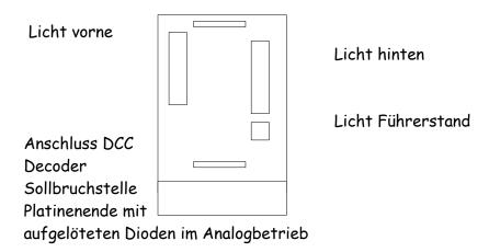
Für den Digitalbetrieb wird dieses Ende abgetrennt (vorsichtig abgebrochen). Der Decoder wird an die vorgesehenen freien Lötstellen angelötet. Dabei ist die Beschreibung der Anschlüsse auch auf der Platine zu finden. Die Belegung ist wie folgt:
