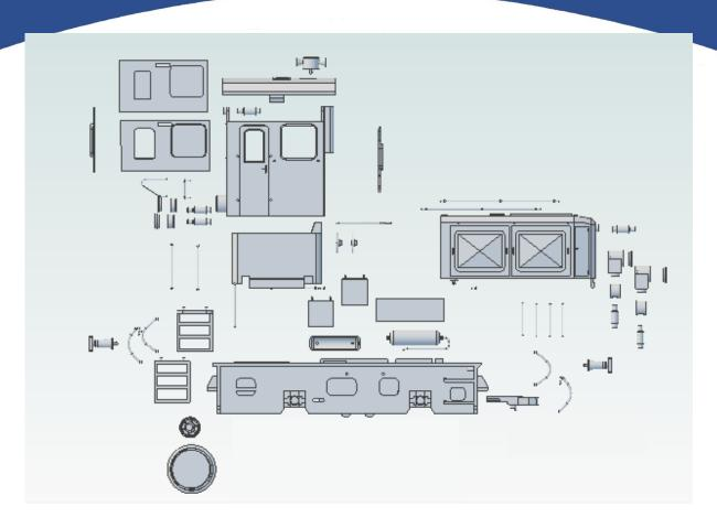
Übersicht der Bauteile zum Modell 2021000/2021002
