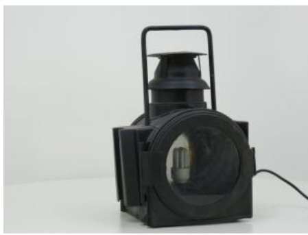
DB Flugelsignal Lampe, 220V Umbau
