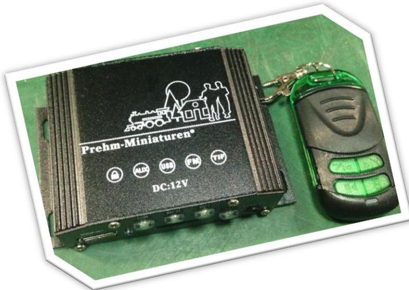
Die Fernbedienung funktioniert nun nicht mehr per Infrarot, sondern per Funk (433Mhz.), was den Einbau in Gebäude und Waggons erlaubt. Die Reichweite beträgt ca. 100m.
