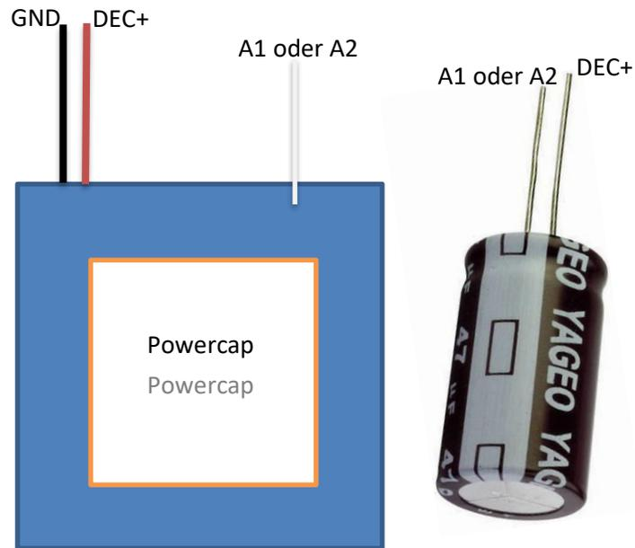
Powercap ODER Kondensator (ab 2000  $\mu$ F Diode/Widerstand (120 Ohm) nutzen)
