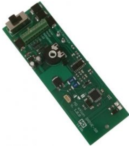
MD DRIVE-SR (Speziallokdecoder für LGB Reinigungsloks mit Soft-Start)
