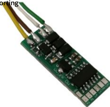
Mxion 4503 DRIVE-S (2A Lokdecoder, SUSI, 4 Funktionsausgänge Mit LGB-Schnittstelle)
